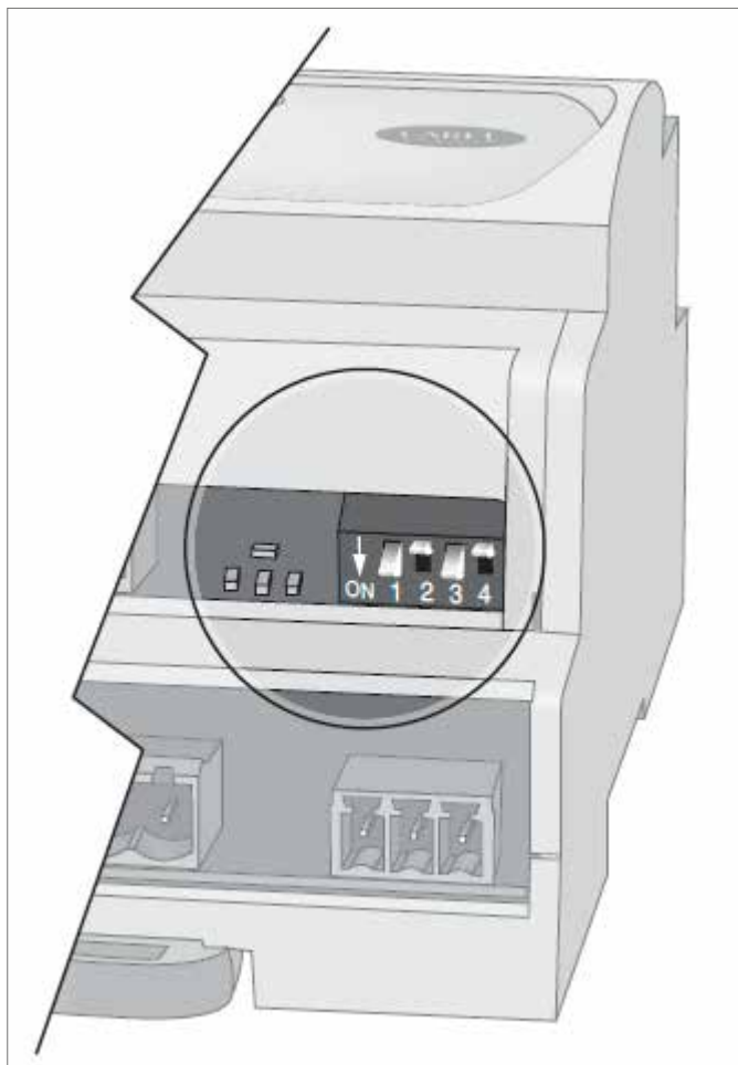
Рис. 6-2 Настройка адреса расширительного модуля HC BUS Manager
